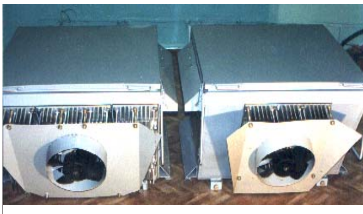
Рис. 9. Внешний вид двух ПУМ (модуль инверторов и модуль повышения напряжения).
